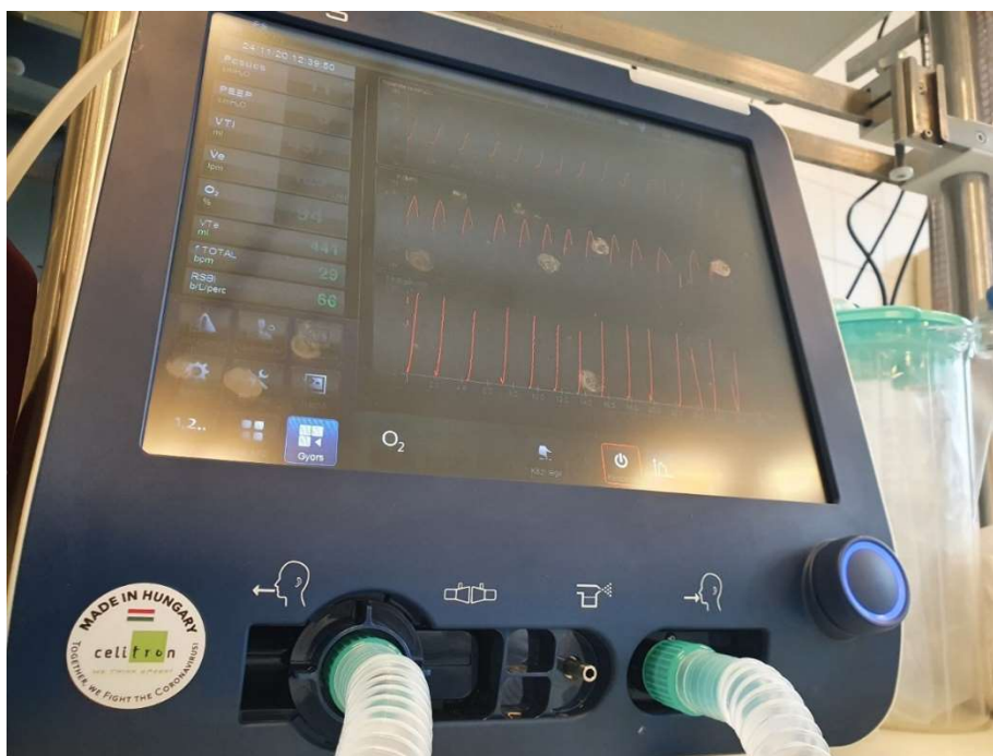
23. kép A Panther5 lélegeztetőgép működés közben az intenzív osztályon - a szerző saját felvétele
