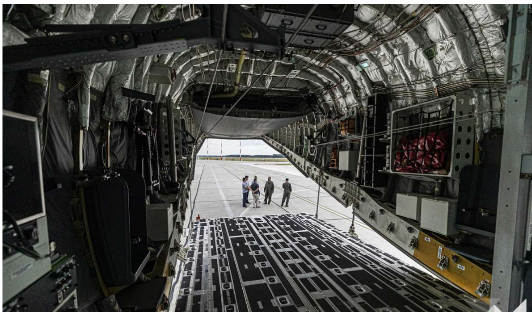
20. kép Az Embraer C-390 szállítógép hátsó, lenyitható rámpája Forrás: https://honvedelem.hu/hirek/csapatmunka-ket-hajtomure.html
