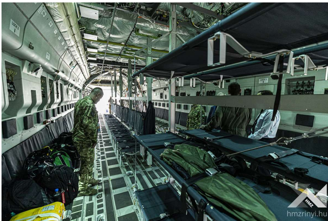
19. kép Az Embraer C-390 szállítórepülőgép hordágy konfigurációja https://honvedelem.hu/hirek/csapatmunka-ket-hajtomure.html
